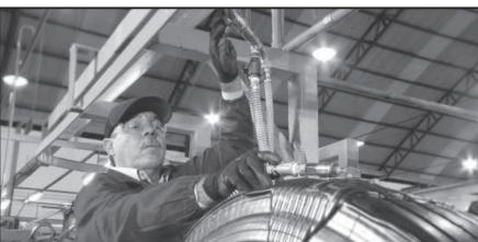
Mantenha o pneu sugado, conduza até o pulmão de vácuo e conecte nas mangueiras secundárias permanecendo até o momento de colocá-lo na autoclave.
