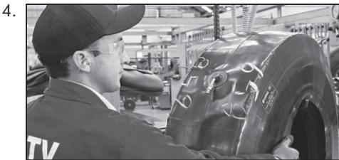
4. Centralize o INNLOP no pneu linearmente para facilitar a montagem.
