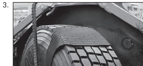
Envelope o pneu, posicionando a borracha degasadora abaixo da válvula e posicionada de 90° a 180° da emenda do pre-moldado. Se for utilizado filme poliéster, é necessário que se faça cortes no filme, sentido circunferencial, onde ela será aplicada.
