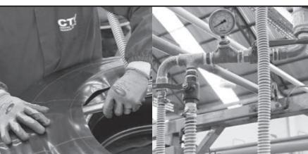
Com o pneu deitado na mesa de montagem, conecte a mangueira espiral para a drenagem do ar (formar vácuo). Para agilizar a formação de vácuo e reduzir o tempo da operação, indica-se a utilização de um aspirador auxiliar ou a aplicação de uma flange metálica para facilitar a vedação. Verificar vazamentos utilizando um vacuômetro. Após a formação do vácuo feche a válvula e aguarde a estabilização do vacuômetro, se o
