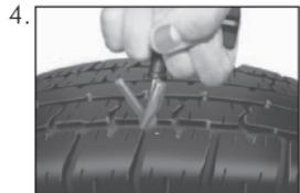
4. Immediatamente introduza o Vipaseal no dano, respeitando a inclinação da perfuração, girando a agulha lentamente até 1/4 de volta (90°).
