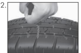
Inflie o pneu um pouco acima do normal. Detecte a inclinação de perfuração com auxílio da agulha especial e faça movimentos rotativos, para acomodar as pontas das lonas e facilitar a aplicação do Vipaseal.
