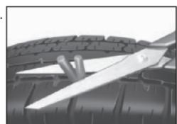
5. Retire a agulha e corte o excesso de Vipaseal, 1 mm acima da banda de rodagem.
